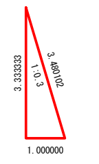
A1橋台掘削法面斜比
